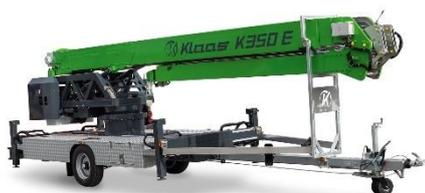
La K350 E est une grue sur remorque de 3,5 tonnes, équipée de technologies avancées, offrant un haut niveau de confort de conduite et d'excellentes performances. Sa capacité de charge maximale est de 1 600 kg, et sa portée latérale avec une charge de 250 kg est de 22 mètres.
