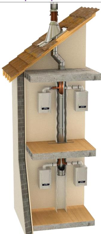
Le système Techna-Flex 3CEPi permet un raccordement individuel de la chaudière pour chaque usager. Le conduit flexible pour l'évacuation des gaz brûlés est facile à mettre en oeuvre et le raccordement flexible thermosoudé (sans joint) permet une étanchéité sans fuite.
