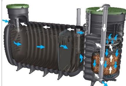
Qu'il s'agisse d'une résidence principale ou secondaire, la filière easyCompact a été spécialement conçue pour traiter les eaux usées domestiques lorsque le raccordement au réseau d'assainissement collectif est impossible. GRAF complète ainsi sa gamme de solutions d'assainissement autonomes avec un système écologique et économique qui ne nécessite pas d'électricité. Grâce au média filtrant révolutionnaire GRAFRock, les eaux sont épurées de manière biologique et naturelle en seulement 3 étapes !
