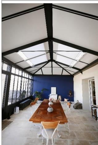
Issues de la recherche spatiale, les toiles réfléchissantes REFLEX'SOL sont composées de rubans de Mylar métallisés qui renvoient le rayonnement solaire à l'extérieur et empêchent le réchauffement des pièces vitrées.
