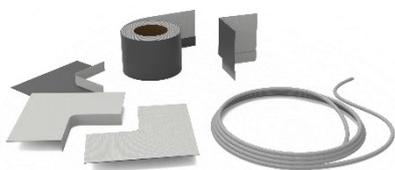
Kit d'étanchéité complet pour garantir l'étanchéité entre receveur encastré, sol et murs. Le kit Duotanche est un système de renforcement d'étanchéité entre receveur encastré, sol et murs. Muni d'une bande auto-adhésive, d'angles préformés, et d'un cordon de désolidarisation, il permet une protection totalement hermétique spécialement dédiée au receveur zéro ressaut.
