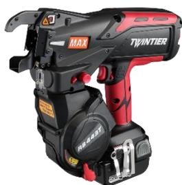
La nouvelle ligatureuse MAX, RB443T, conserve les fonctionnalités innovantes de la précédente RB441T, mais elle est encore plus rapide et plus facile à utiliser. Le temps nécessaire pour réaliser un noeud a été réduit à seulement 0,5 seconde grâce à l'alimentation en fil, qui est devenue encore plus fluide en revoyant fondamentalement le mécanisme en alimentation du fil, la traction et la torsion. Cette nouvelle version comprend également une fonction d'aide à l'alimentation en fil.
