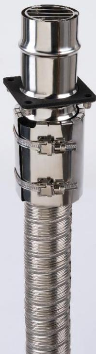
PEGASUS FLEXISHUNT est un système qui permet l'installation des chaudières à condensation THPE en rénovation sur un conduit shunt ou alsace. Ce système assure l'évacuation des produits de combustion d'appareils à gaz condensation haute pression à circuit de combustion étanche de type C9, C(15) en réutilisation d'un conduit de fumée collectif existant de type Shunt ou Alsace.
